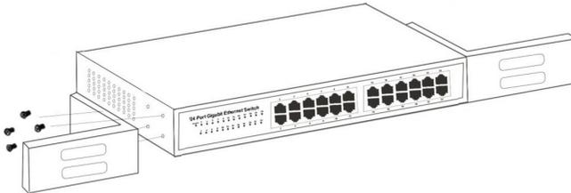
Bringen Sie die Befestigungsklammern an den Seitenteilen des Steckers (einen an jeder Seite) an und sichern Sie sie mit den beiliegenden Schrauben.
