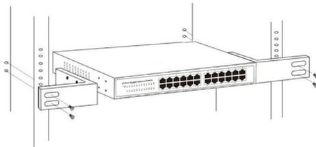
Verwenden Sie die als Zubehör beiliegenden Schrauben, um den Intellinet Data Schalter auf dem Gehäuse anzubringen.
