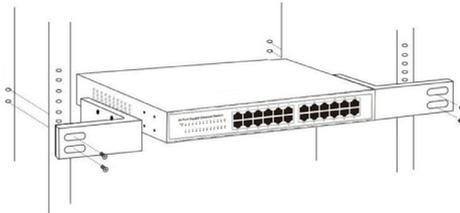
Utilice los tornillos que se proporcionan con el bastidor del equipo para montar el switch (conmutador) de datos Intellinet en el bastidor.
