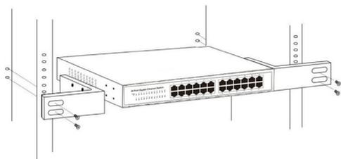
Utilizzare le viti fornite con il rack dell'apparecchiatura per montare lo switch dati Intellinet sul rack.
