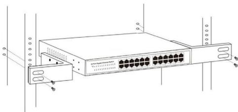
Użyj dostarczonych ze stojakiem śrub, aby przymocować przełącznik Intellinet do stojaka.
