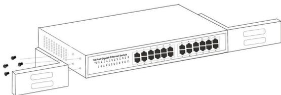
Przytwierdź klamry montażowe do bocznych paneli przełącznika (po jednym z każdej strony) i zabezpiecz je dostarczonymi śrubami.
