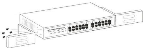
Fissare le staffe di montaggio sui pannelli laterali dello switch (uno su ciascun lato) e assicurarli con le viti in dotazione.
