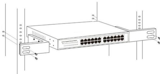
Utilisez les vis fournies avec le rack d'équipement pour monter le commutateur de données Intellinet sur le rack.
