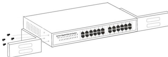
Fixez les supports de montage sur les panneaux latéraux du commutateur (un de chaque côté) et fixez-les à l'aide des vis fournies.
