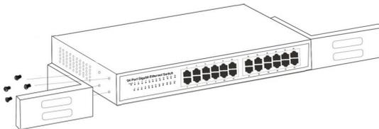
Fije los soportes de montaje en los paneles laterales del switch (uno en cada lado) y asegúrelos con los tornillos que se proporcionan.
