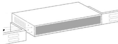
Utilice los tornillos que se proporcionan con el bastidor del equipo para montar el switch (comutador) de datos Intellinet Network Solutions en el bastidor.
