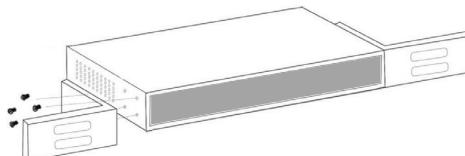
Verwenden Sie die als Zubehör beiliegenden Schrauben, um den Intellinet Network Solutions Data Schalter auf dem Gehäuse anzubringen.
