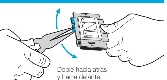
No quite las secciones laterales externas de los atenuadores al final de la conexión.
