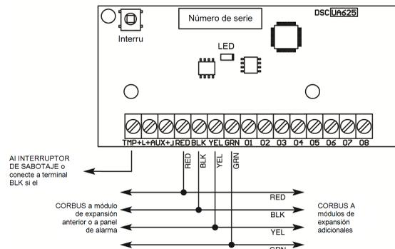
**O1 a O8** - Conecte el cable positivo del dispositivo a la terminal AUX; y el cable negativo, a la terminal de salida requerida (O1 a O8).
