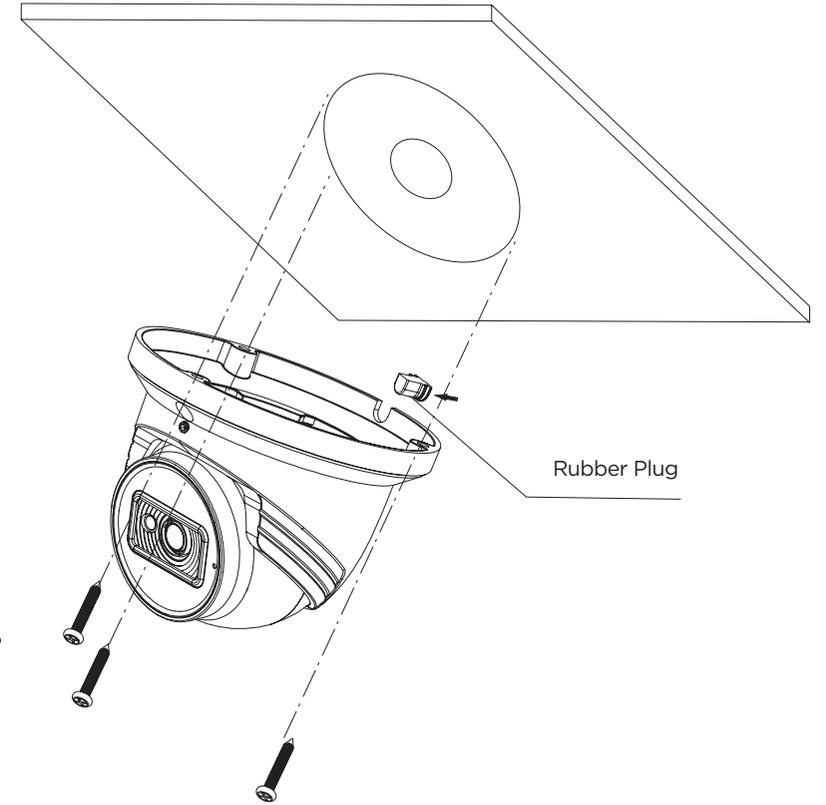
**STEP 3 - INSTALLING THE CAMERA**
