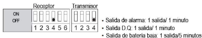
Figura 37. Interruptor DIP y ajustes de salida
